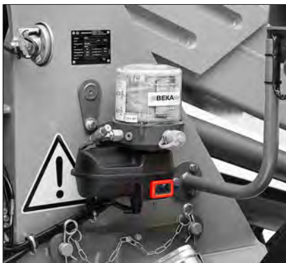
Abb. 217: Positionierung der Zentralschmieranlage am Fahrzeug
