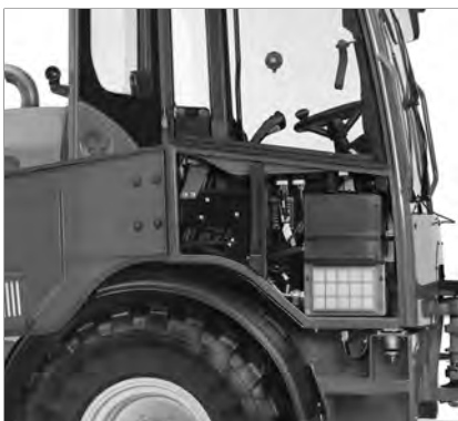
Abb. 171: Wartungsklappe in der rechten Seitentür
