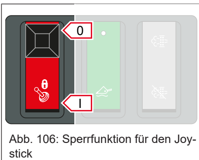
Abb. 105: Sperrfunktion für den Joystick
