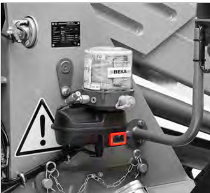
Abb. 186: Positionierung der Zentralschmieranlage am Fahrzeug
