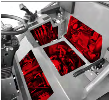
Abb. 170: Wartungsöffnungen in der Kabine
