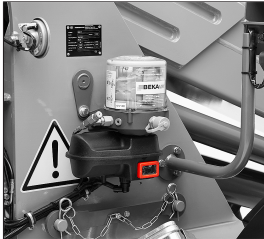
Abb. 175: Positionierung der Zentralschmieranlage am Fahrzeug
