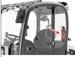
Abb. 3: Montageplatz für den Feuerlöscher
