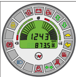
Abb. 58: Übersicht der Warnleuchten und Kontrollleuchten
