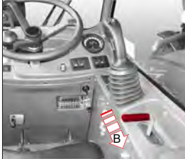
Abb. 123: Dauerbetrieb der Hydraulikanschlüsse
